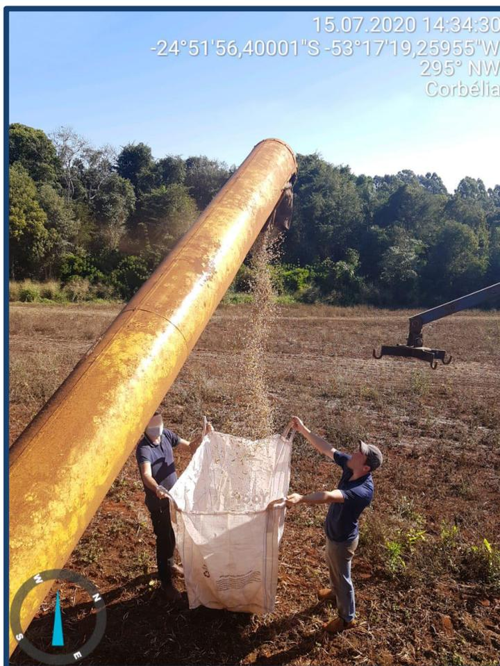
Para classificação e medição da umidade da amostra, o perito pode dispor de equipamentos portáteis, específicos para esse uso ou coletar amostras homogêneas da massa colhida e levar até uma unidade de secagem e armazenamento, próxima, para realizar a análise.
